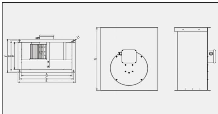
Используется для передачи воздушного потока по каналам вентиляционной системы, а также увеличения его напора для лучшего воздухообмена. Вентилятор имеет шариковые подшипники, поэтому его можно монтировать в любом из доступных положений.
