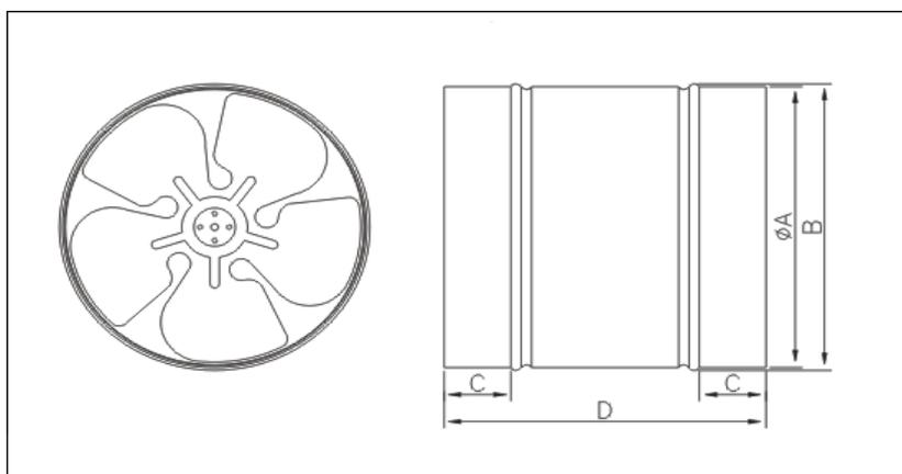
Применяется для транспортировки и усиления воздушного потока в вентиляционных каналах. Двигатель вентилятора оборудован шариковым подшипником, что даёт возможность монтажа в любом положении и увеличивает срок службы устройства. К вентилятору в комплекте идёт крепление для монтажа.
