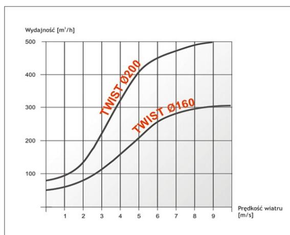
Дымовой дефлектор Дефлектор предназначен для усиления или побуждения тяги с помощью усиления напора воздуха, проходящего через вентиляционную шахту. Дефлектор благодаря флюгеру – способен перемещаться против направления ветра. Предназначен для дымоудаления, устанавливается на кровле, на головке дымового канала. Обладает защитной формой, благодаря которой в помещение не попадают осадки.
