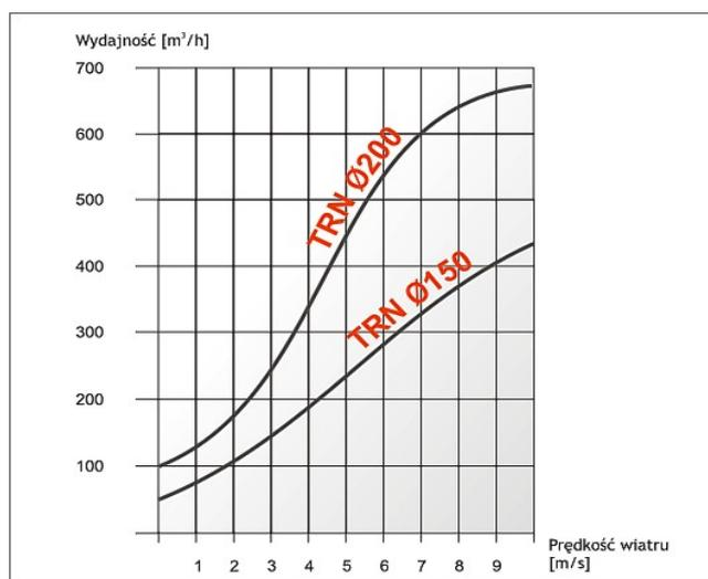
Устанавливается на выходе вентиляционной шахты (обычно на крыше здания). Применяется для увеличения мощности и способности вентиляционной системы или дымовой шахты путём увеличения тяги. Противодействуют созданию обратной тяги и защищают от попадания атмосферных осадков внутрь здания. Производится из оцинкованного железного листа или железного листа с хромо-никелевым кислотоотпорным покрытием
